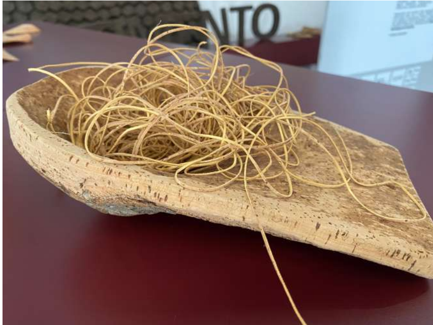
Figura 43 - Fio desenvolvido a partir de fécula de batata e cortiça. Fonte: Imagem do Autor.
