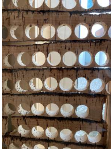
Figura 25 - Amostras de pranchas de cortiça depois da produção de rolhas. Fonte: Imagem do Autor.
