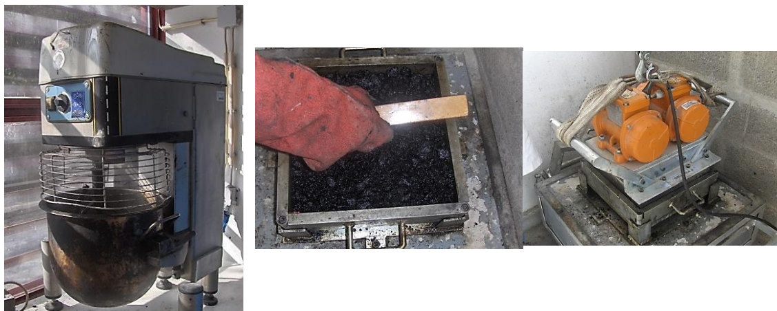
Figura 4.11 - Principais etapas da produção dos provetes para o ensaio wheel tracking .
