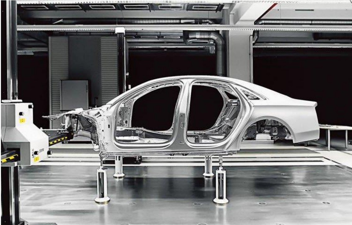
Figura 13 - Carroçaria ultra-leve em alumínio, Audi space Frame, 1994
