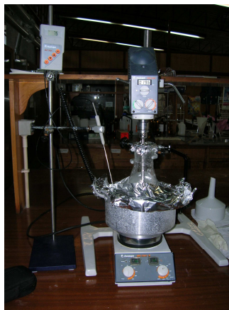
Figura 4.3 Montagem de cozimento do amido
