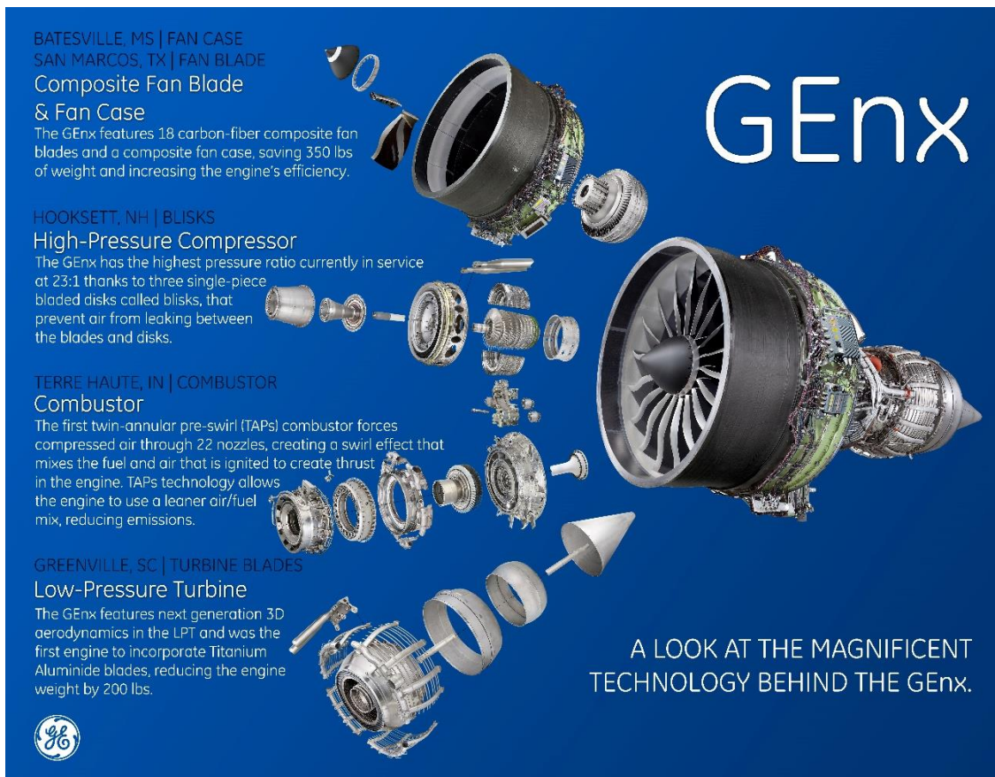
Figura 2.9 – Motor GENx produzido para o Boeing 787 Dreamliner e 747-8 [20].
