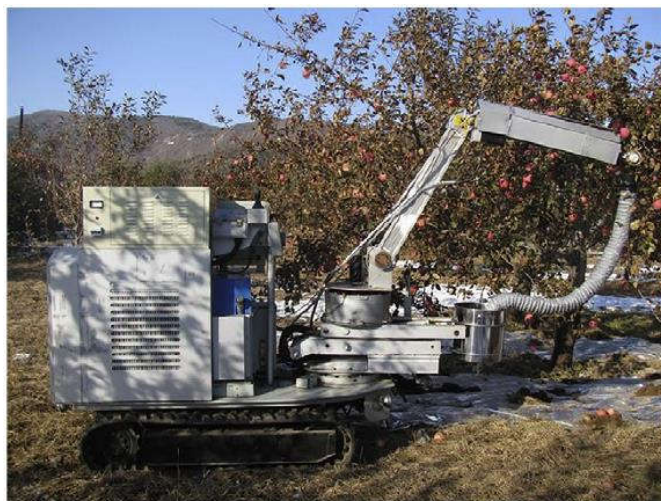
Figura 1 – Ensaios de campo de um sistema autónomo de colheita de frutos baseado num manipulador PRRRP (De-An et al. , 2011).
