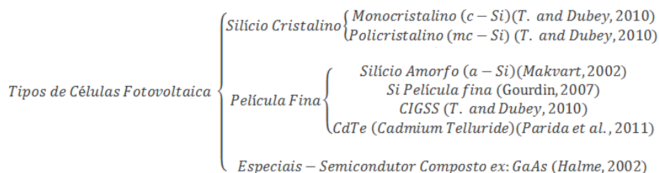
Figura 8: Esquema da tecnologia fotovoltaica existente para a produção de células solares.
