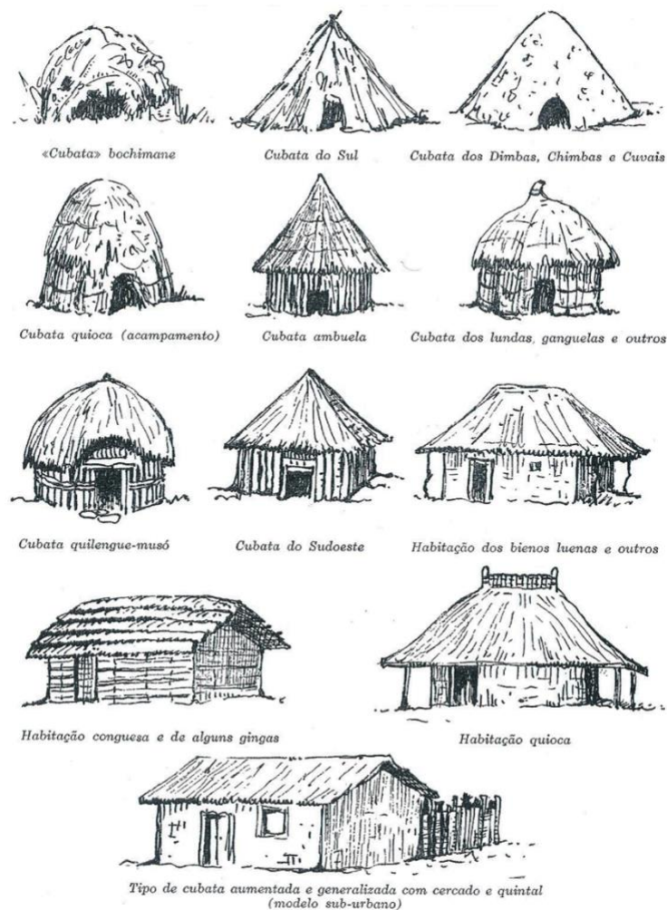
Figura 13- Habitações nativas de vários grupos étnicos, seguindo a evolução até ao modelo suburbano. Fonte: (Redinha, 1964).
