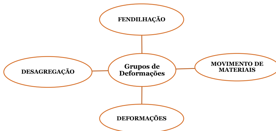
Figura 5- Grupos de mecanismos de degradação de pavimentos (adaptado de Domingos, 2009)
