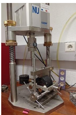
Figura 18 – Ensaio de módulo de rigidez por tração indireta.
