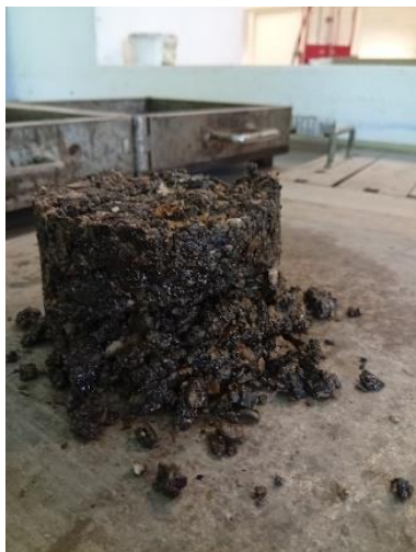
Figura 29 – Provetes sem coesão após 2 horas de cura
