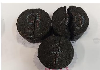
Figura 33 – Provetes após compressão apresentando rotura do tipo C
