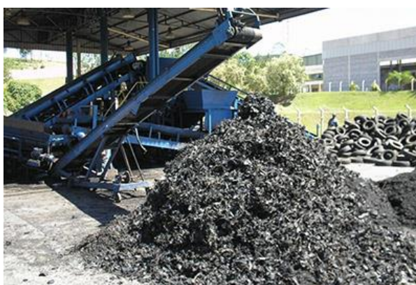
Figura 1 -Triturador de pneus de borracha (UTEP, 2025)
