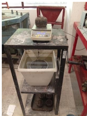
Figura 16 – Sistema de pesagem dos provetes, secos imersos e húmidos
