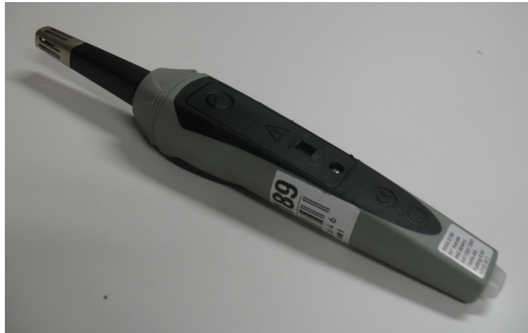
Figura 3.3 - Sonda de rádio frequência para determinar temperatura e humidade
