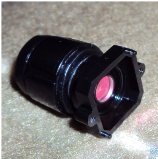
Fig.72 - Lente isolada, com o filtro infra-vermelho
