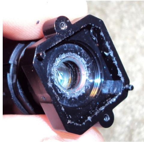
Fig.74- Zona a desgastar na lente
