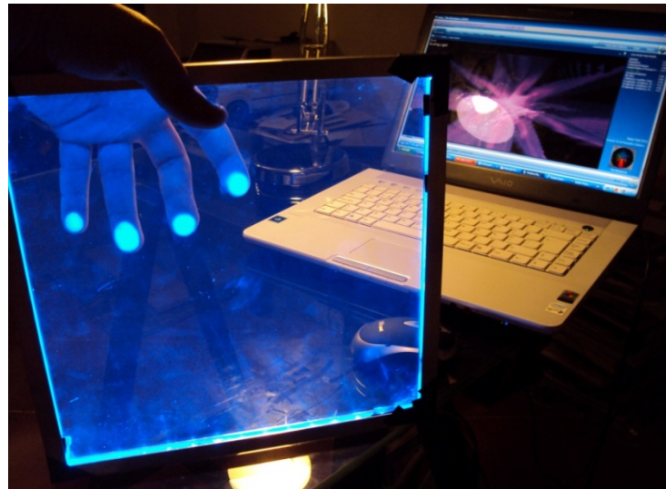
Fig.53 - Teste do efeito da frustração total da reflexão interna da luz (FTIR)
