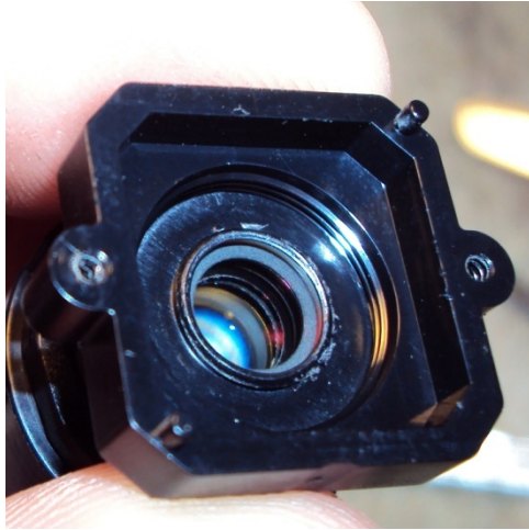
Fig.73 - Lente com filtro IR
