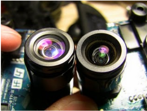
Figuras 65 e 66 – Lente má à esquerda e lente boa à direita
