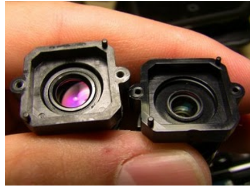
Figuras 65 e 66 – Lente má à esquerda e lente boa à direita
