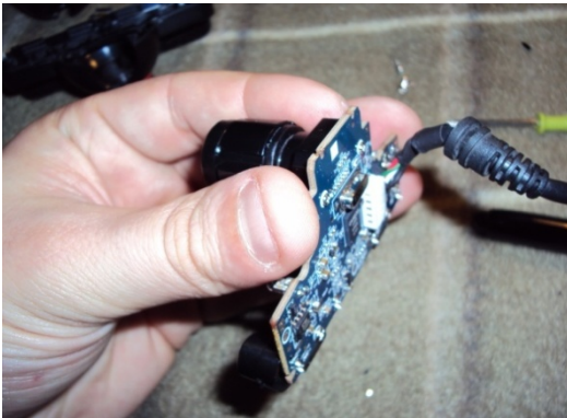
Fig.69 – Circuito da câmara com a lente
