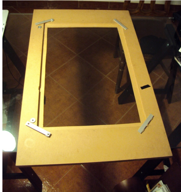
Fig.61 – Sistema aplicado para segurar o acrílico ao tampo de madeira
