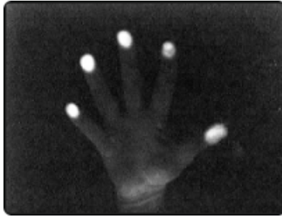
Fig.25 - Pontos de contacto capturados pela câmara
