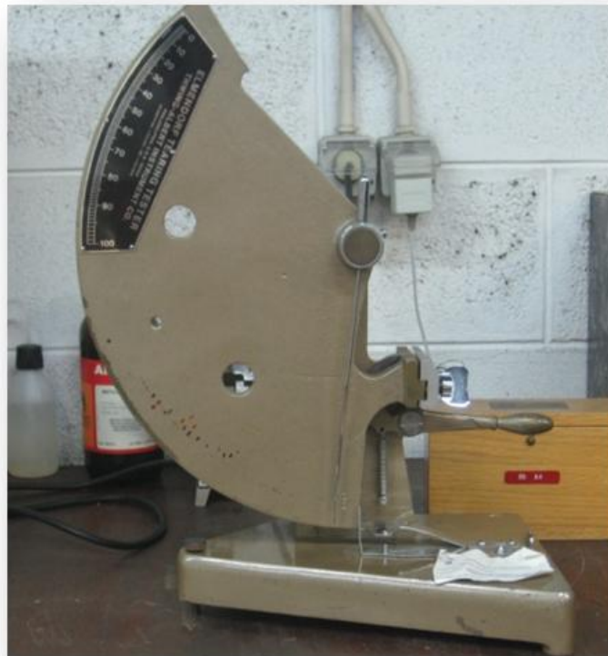
Figura 2.9.: Aparelho Elmendorf para determinar o rasgamento de tecidos na teia e na trama, Laboratório de Ensaios Físicos do Departamento Têxtil da UBI
