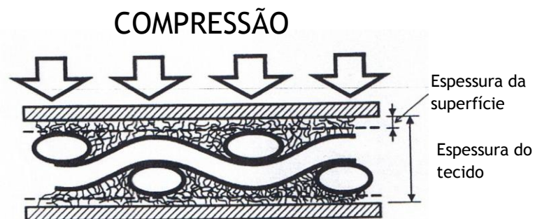
Figura 2.20.: Princípio de medição do FAST-1, compressão (Fonte: catálogos do FAST)
