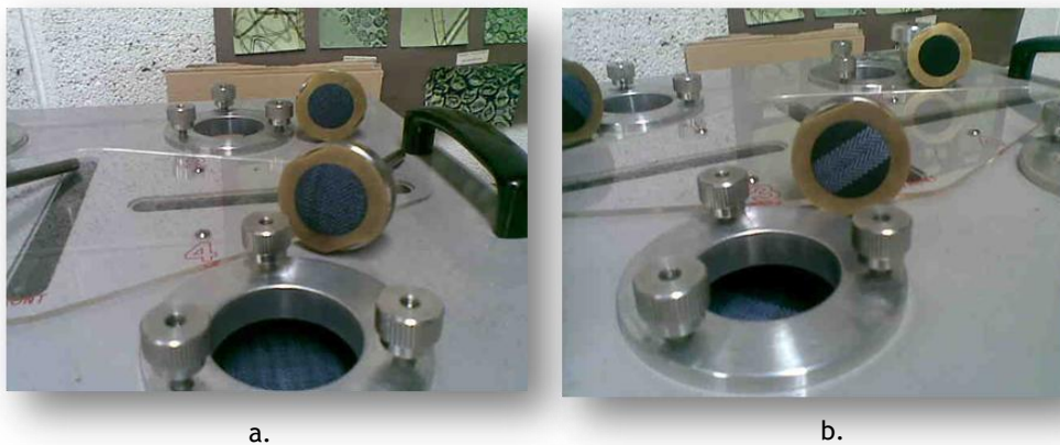
Figura 2.12: Abrasímetro Martindale para avaliar a propensão para a formação de borboto dos tecidos; a. tecido duplo e b. tecido simples, Laboratório de Ensaios Físicos do Departamento Têxtil da UBI
