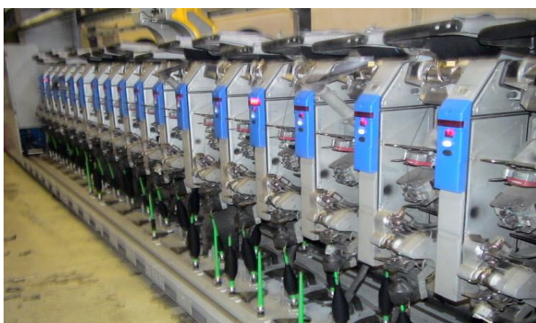
a) Processo de bobinagem e depuração.
