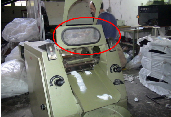
a) Protecções retiradas.
