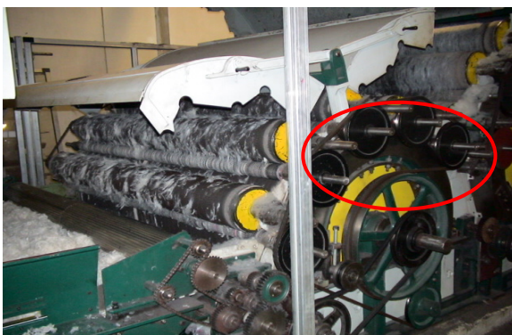
a) Elementos móveis rotativos desprotegidos.
