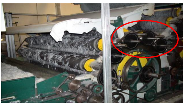
a) Elementos móveis rotativos desprotegidos.
