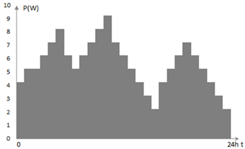
Figura 5.6- Exemplo de diagrama de carga da saída 1 do quadro 2.
