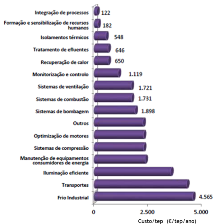
Figura 2.17- Potencial de economia de energia por tipologia de medida (Custo/tep), (Fonte: [ADENE14]).
