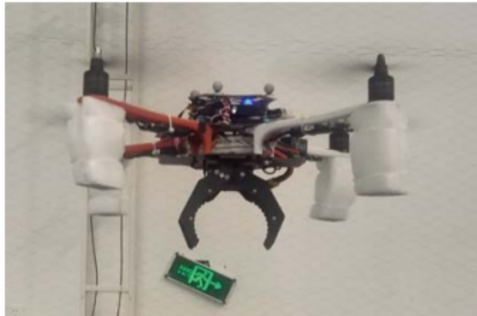
Figura 2.13: Garra implementada num quadrotor em Juntong Qi et al. [25].
