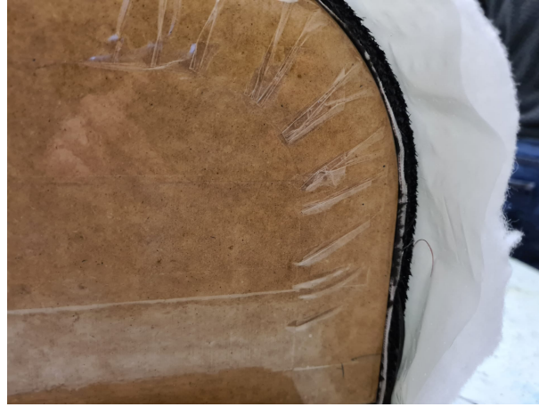
Figura 4.23: Laminação das diferentes fibras usadas para a construção da perna traseira.
