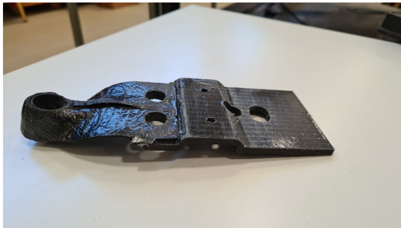
Figura 4.27: Peça principal de suporte e de ligação das pernas do trem de aterragem bem como do sistema de transporte.
