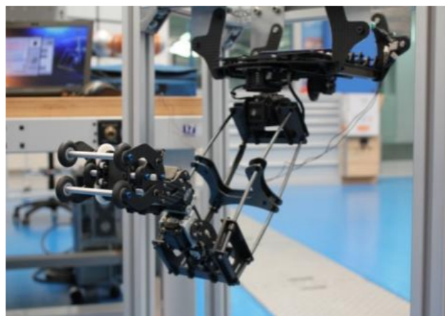
Figura 2.14: Braço robotizado para construção de pequenas estruturas de R. Cano et al. [27].
