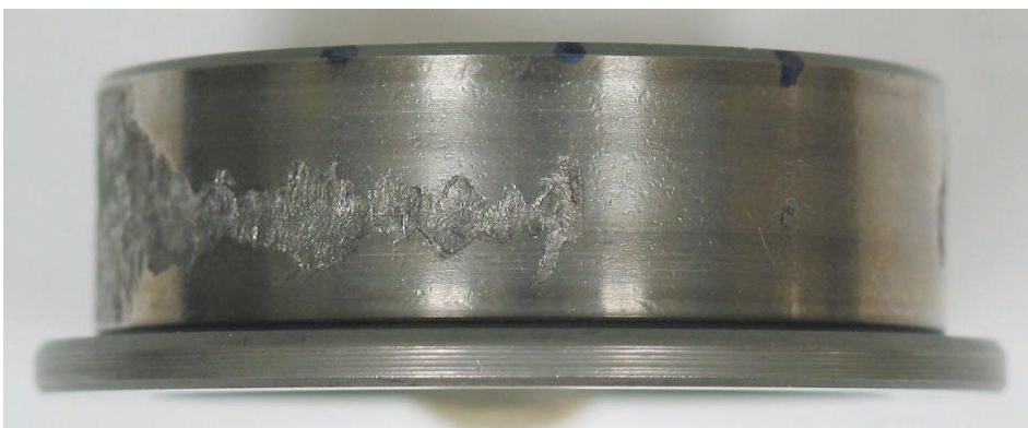
Figura 1.4 - Descamação da superfície de um rolamento [45].
