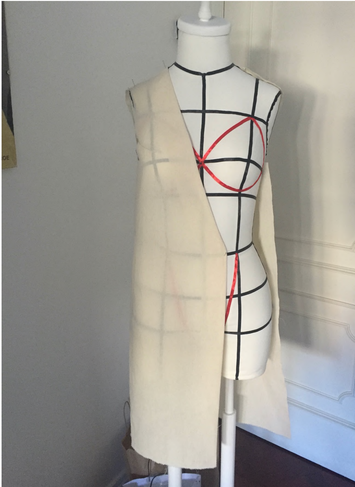
Fig.48 – Verificação dos moldes já cosidos. Fonte: Autoria própria
