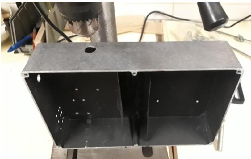
Figura 7.16: Caixa metálica de proteção do circuito eletrônico.
