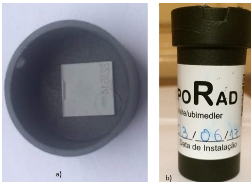
Figura 5.1: a) Detetor passivo CR-39 b) Câmara de difusão.
