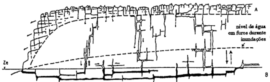
Figura 2.1 - Hidrogeologia de um maciço sedimentar. (A) zona de recarga; (B) zona de cavidades saturadas; (C) zona de transferência [33].
