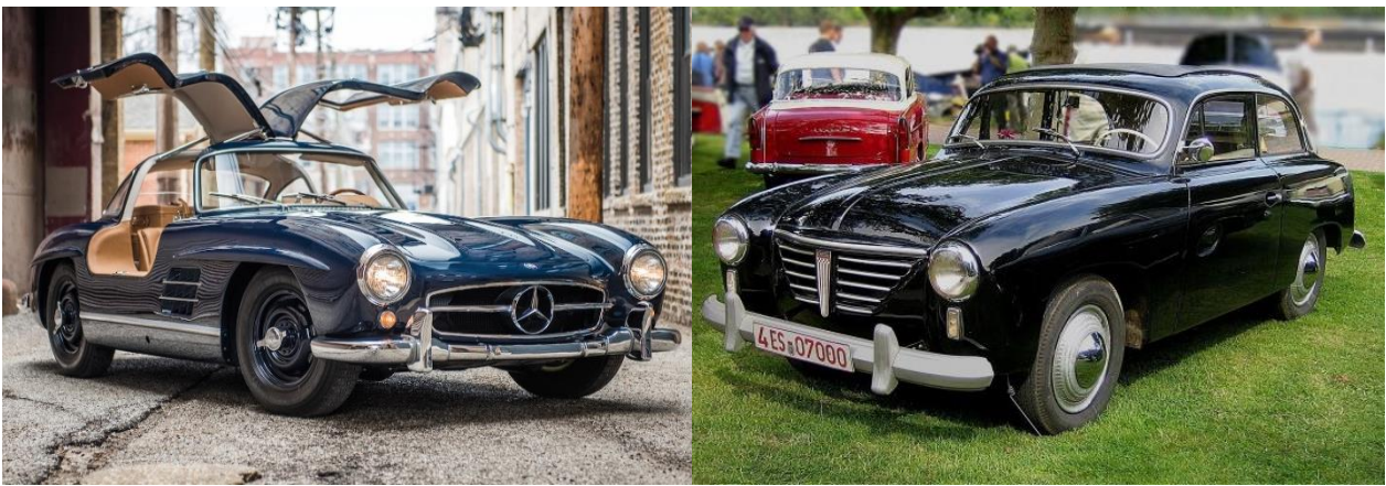
Figura 18 – Primeiros veículos de produção em série com sistema de injeção direta: à esquerda o Mercedes-Benz 300 SL de 1954 e à direita o Goliath GP700 de 1952. [15] e [16]
